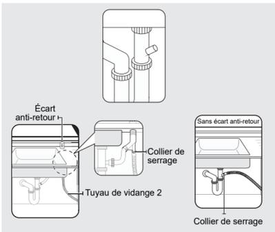
**Raccordement à la vidange avec un broyeur à déchets avec et sans écart anti-retour.**
