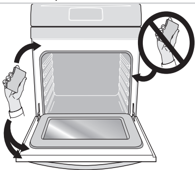
Figure 52: Limpie alrededor de la junta de la puerta del horno
